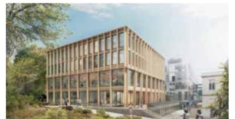
Die Gebäudehülle des BOKU-Neubaus ist großteils eine Pfosten-Riegel-Konstruktion mit 3-fach-Verglasung. Die Fassade besteht aus unbehandeltem Lärchenholz.
